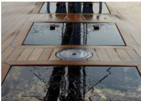
auch die bekannten Offshore Luken bieten viele durchdachte Kleinigkeiten. Vom flach aufliegenden Rahmen, damit sich kein Tauwerk verhakt, bis hin zu den einfach auswechselbaren Dichtungen - bei Moonlight wird an den Bordalltag gedacht! Für weitere Informationen sowie Katalogmaterial senden Sie uns gerne eine eMail oder rufen Sie uns an!
